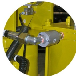
气管防爆裂系统
